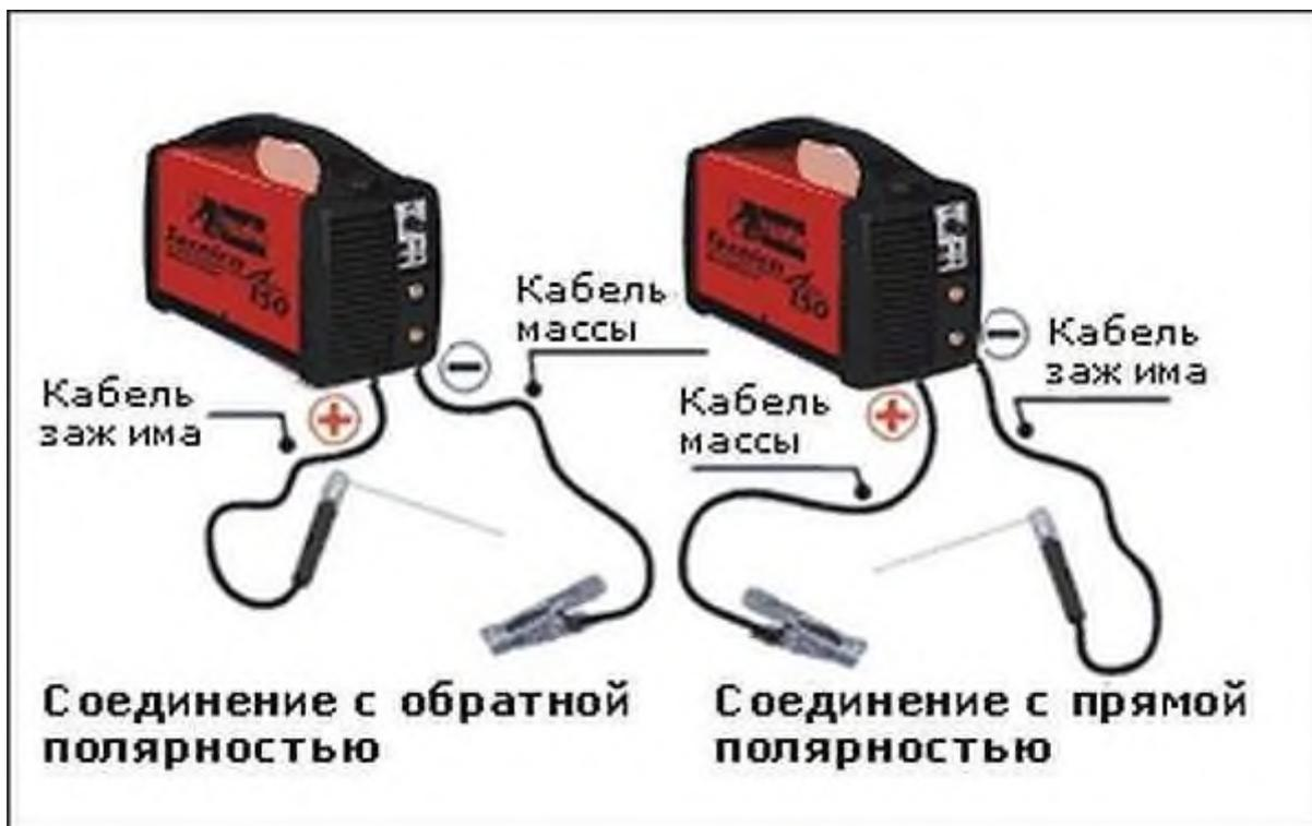
Прямая и обратная полярность подключения на сварочном инверторе
