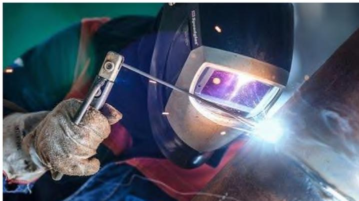
Сварное соединение металла на сегодня — самое надежное: куски или детали сплавляются в единое целое. Происходит это в результате воздействия высоких температур. Большинство современных сварочных аппаратов для расплавления металла используют электрическую дугу. Она разогревает металл в зоне воздействия до температуры плавления, причем происходит это на небольшой площади. Так как используется электрическая дуга, то и сварка называется электродуговой.
