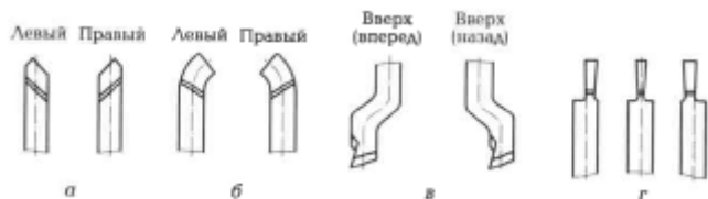
Рисунок 12 Резцы прямые (а), отогнутые (б), изогнутые (в) и с оттянутой
